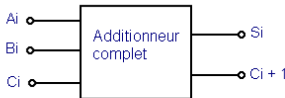
Fig. 5. - Représentation schématique d'un additionneur complet.
